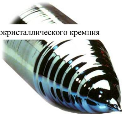
Рисунок 12. Слиток монокристаллического кремния
