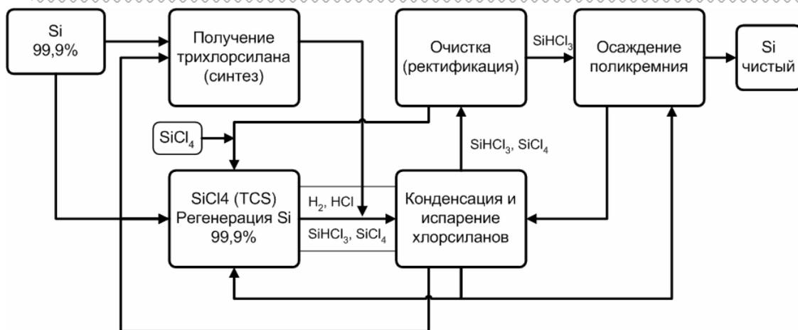
Данная схема не включает другие хлорсиланы (моно-, ди-, полихлорсиланы), образующиеся в незначительных объемах. Не включены потоки безопасности – азотная защитная атмосфера и образование отходов.
